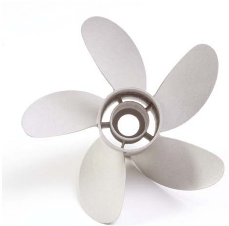
Масштабная модель приводного гребного винта для гоночных лодок для измерения характеристик
